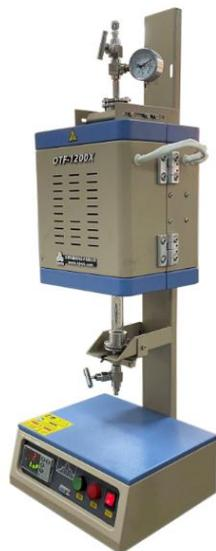
OTF-1200X-S-VT 是一款通过 CE 认证的小型管式炉，其最高工作温度为 1200℃，额定功率为 1200W。炉管可配置为 1" 或 2" 的高纯石英炉管，炉管两端已安装一对不锈钢法兰（法兰上已安装机械压力表、不锈钢截止阀）。此款设备允许样品在真空和气体保护下进行烧结。精确温控系统包含了 30 段升温 and 降温曲线设置，其控温精度达到  $\pm 1^{\circ}\text{C}$
