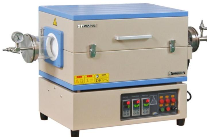
OTF-1200X-III-S 是一款三温区开启式管式炉，其最高工作温度可以达到 1200℃（1200℃<1h）。炉管为高纯石英管。设备配有一对不锈钢密封法兰，可在真空或气氛保护环境下对样品进行热处理。对于控温系统，可设置 30 段升降温程序，控温精度为 $\pm 1^{\circ}\text{C}$ 。
