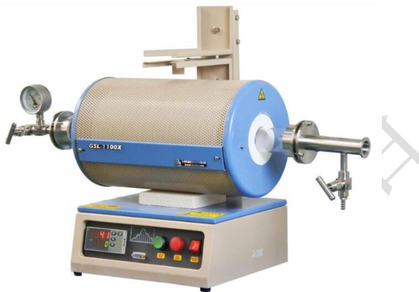
GSL-1100X-S 是一款已通过 CE 认证的小口径管式炉，是专为制备小样品设计，最高温度可达 1100℃，标配内包含不锈钢密封法兰与石英管，客户接通电源即可立即使用。30 段可编程精密温度控制器，可根据不同的客户需求来设定升降温程序。控温精度±1℃。炉体可垂直或水平放置以满足不同的应用，如 VSL、VD 等淬火试验
