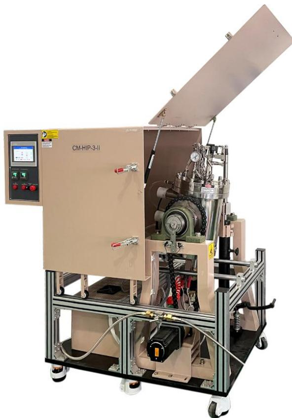
CM-HIP-3-II 是一款小型内加热式热等静压炉，其有两套  $\Phi 80 \times 120$  H mm 加热腔组成，此设备最高加热温度可达  $1300^{\circ}\text{C}$ ，此温度下最高压力为 10MPa (不得使用有毒和腐蚀性气体)。
